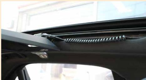
モニター裏のHDMI入力へ専用ケーブルにて有線接続。特殊なHDMIケーブル採用により、モニターのスライドや収納時もレールに噛みこむことはありません。
