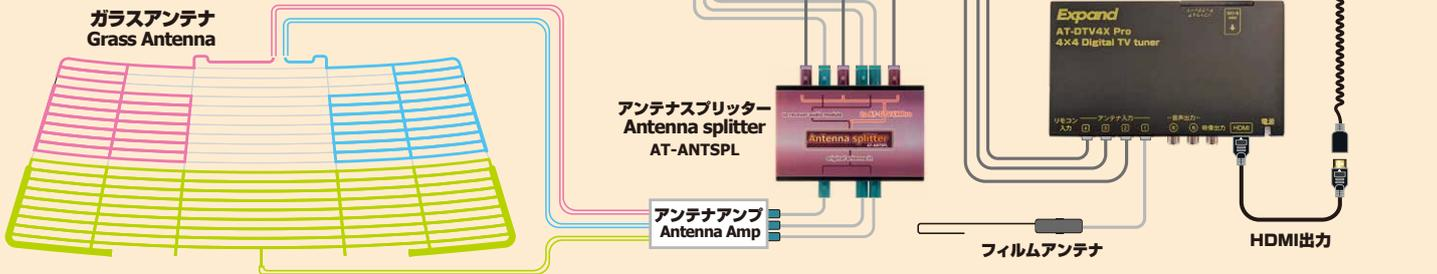
赤外線を通さないクライメントコンフォートガラスは、弊害として電波も遮断します。地デジアンテナは、純正リヤガラスアンテナを併用。専用設計の分配器でロスなくTV電波を受信します。また、ドラレコ電波干渉も受けにくくなります。
